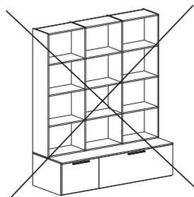
La spalla sovrapposta deve essere in corrispondenza del fianco del contenitore base e va ancorata al muro.
