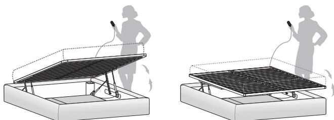
\* Il motore elettrico per l'apertura motorizzata prevede l'allacciamento alla rete domestica sul lato testiera. Viene fornito con spina EU, oppure a richiesta con spina britannica a 3 poli. Il telecomando in dotazione funziona tramite collegamento con filo.
